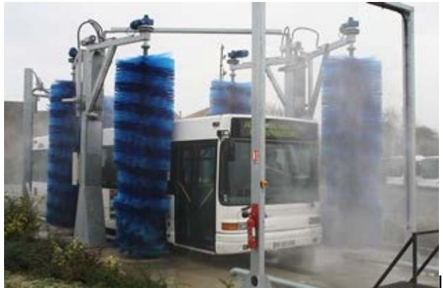
conducente avanza il veicolo e spinge la spazzola verticale anteriore destra. L'apertura della spazzola verticale anteriore destra provoca la chiusura della spazzola verticale posteriore destra.
