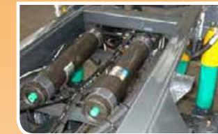
Sospensione oleodinamica con cilindri idraulici doppio effetto Oleodynamic suspension with double-acting hydraulic cylinders
