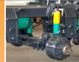
Sospensione oleodinamica con cilindri idraulici doppio effetto Oleodynamic suspension with double-acting hydraulic cylinders
