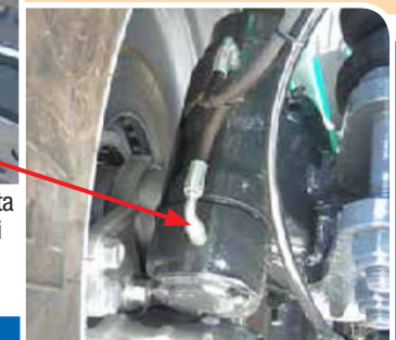
Lubrificazione centralizzata degli assali autosterzanti Centralized lubrication of self-steering axles
