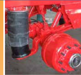
Sospensione pneumatica con diapress e semibalestra tipo Z Air suspension with diapress and spring type Z
