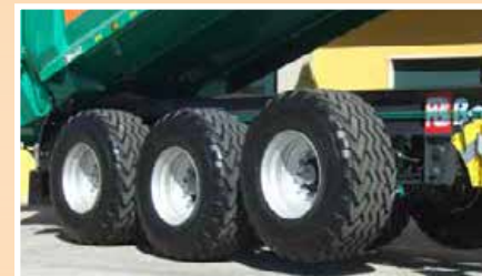
Sollevamento del 1° asse per l'incremento del carico sul gancio di traino, per veicoli a 3 o 4 assi Lifting 1st axle to increase the load on the eyelet, for vehicles with 3 or 4 axles
