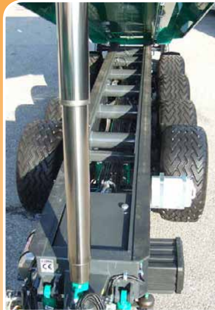
Telaio in trave industriale con traverse di irrigidimento a sezione circolare Industrial chassis reinforced with tubes of circular section
