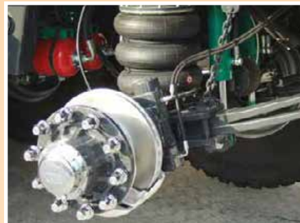
Frenatura a disco con pinza per alte velocità Disc braking with caliper brake for high speed
