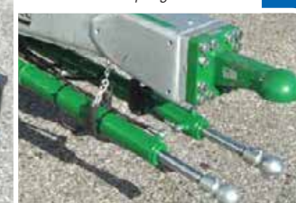
Cilindri di comando con attacchi a calotta K50 Forced steering cylinders with coupling K50
