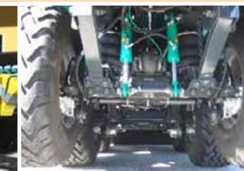
Sollevamento del 1° asse per l'incremento del carico sul gancio di traino, per veicoli a 3 o 4 assi Lifting 1st axle to increase the load on the eyelet, for vehicles with 3 or 4 axles
