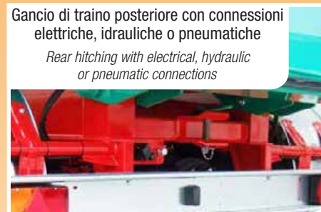
Gancio di traino tipo F2 Hitching eyelet type F2
