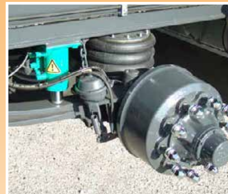
Stabilizzatori idraulici posteriori Hydraulic rear stabilizer cylinders
