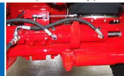
Cilindro di comando assale con trasduttore angolare per sistema di sterzata comandata elettro-idraulica Control cylinder axle with angular transducer for electro-hydraulic forced steering system
