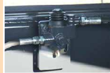
Valvola di sicurezza contro l'apertura accidentale del portellone Safety valve against accidental opening of the rear door
