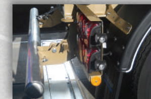
Paraurti rovesciabile pneumatico con barra para incastro tonda in alluminio
