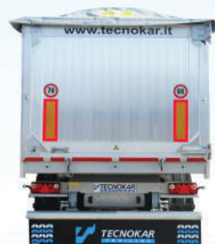
Sponda posteriore basculante a bandiera senza controtelaio
