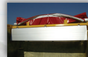
Sovrasponda protezione copertura
