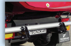
Paraurti rovesciabile pneumatico con barra para incastro tonda in alluminio (in ribaltamento)
