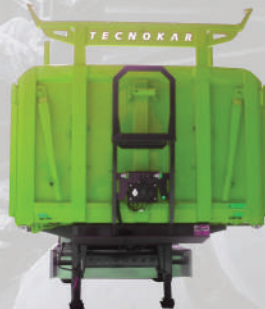
Sponda anteriore rinforzata con castelletto telescopico
