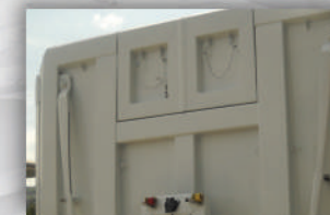
Portelli ispezione sponda anteriore
