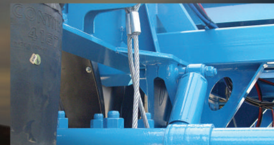
CAVETTI DI SOSTEGNO ASSALI
