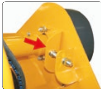
Tenditore cinghia a vite. Screw type belt tensioner.
