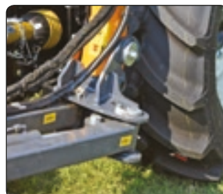
Il pistone per lo spostamento idraulico è interno ai bracci del parallelogramma. Side shift hydraulic ram located inside the parallel arms.
